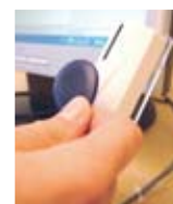
USB-RIF – Interface-box med kortläsare för inläsning av kort, snabbsökning och inloggning i systemet
